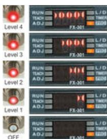
Štandardný model s červenou LED diódou FX-301 (P) bol vylepšený rozšírením jeho stability snímania a je vybavený šíkovnými funkciemi ako je funkcia voľby rozsahu vysielaného svetla. Tým je uľahčené použitie vláknových senzorov pri zachovaní vynikajúcich prevádzkových vlastností konvenčných modelov.
